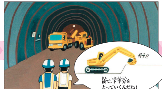
10 上半・下半作業 断面を上半と下半に分けて、先に上を掘って、その後、下を掘っていきます。
