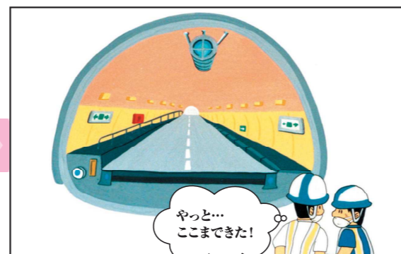
13 トンネル防災・舗装・照明設備 消火設備などの防災設備を整え、照明設備を取り付けます。道路を舗装して仕上げます。
